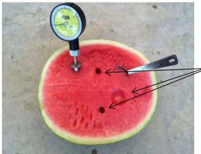
Рис. 2.5 Орієнтовні місця відбору проб для визначення твердості/щільності та показника ^{\circ}\text{Brix}
